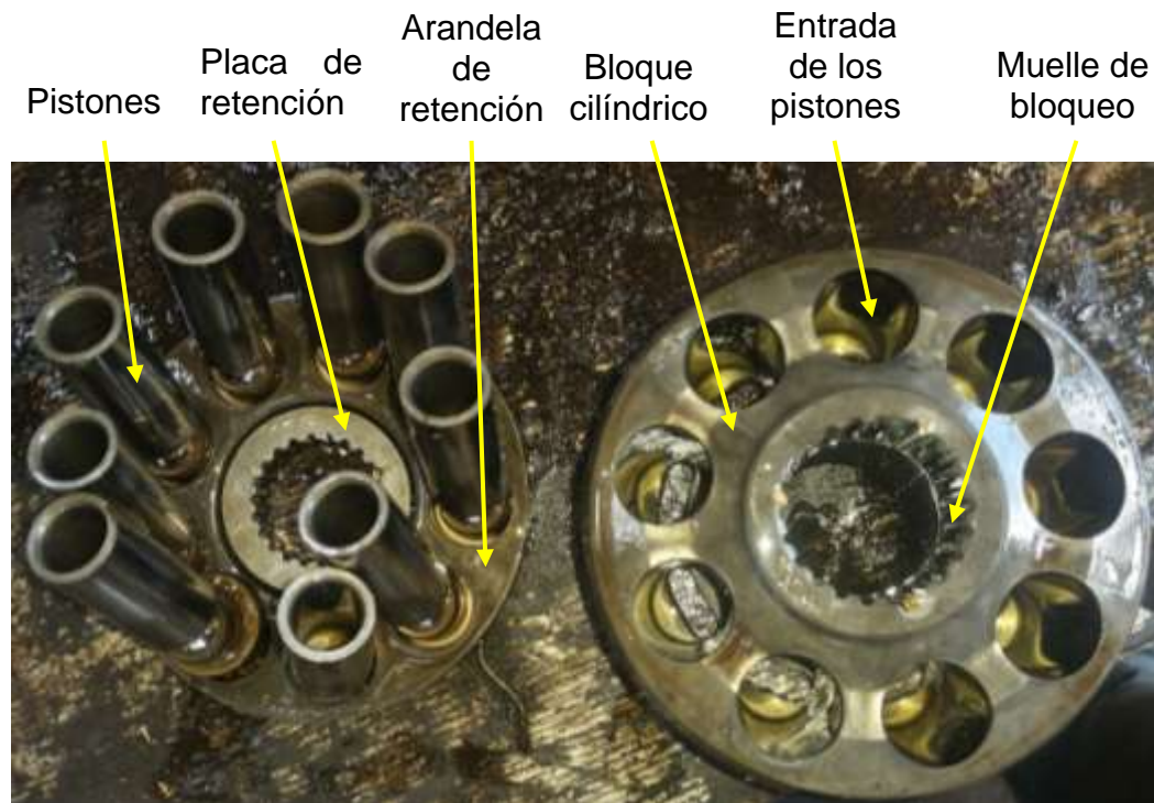
Figura 4.13 Pistones, plato inclinado y el bloque cilíndrico.
