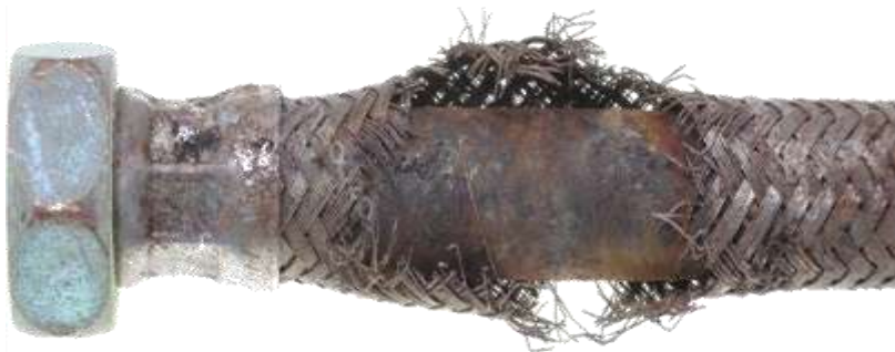
Figura 4.1. Manguera hidráulica dañada.
